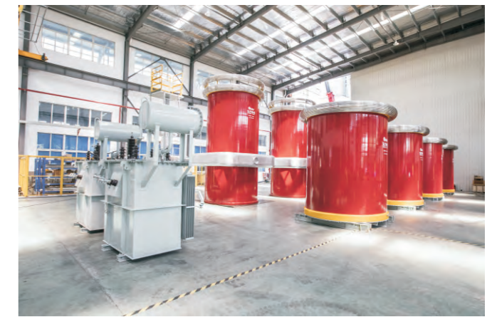
大长度500kV交流耐压试验系统 Large length 500kV AC withstand voltage test system
