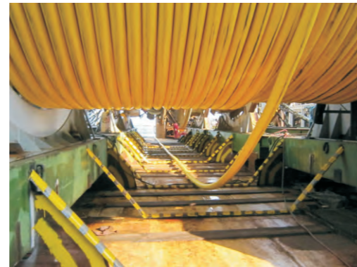
伊朗SP19水下生产系统脐带缆 Iran SP19 Subsea Production System Umbilical
